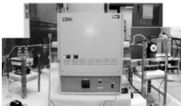
セシウム除去性能実証ラボ試験装置
